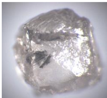
Рис. 11. Обломок коричневого комбинационного грубослоистого кристалла (ряд октаэдр – додекаэдр) с полицентрическим строением граней. На поверхности «додекаэдроида» наблюдаются занозистая и шагреновая скульптуры, многочисленные полосы пластической деформации. Со стороны одной из граней «додекаэдроида» видно крупное графитоподобное включение
