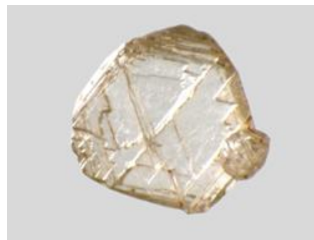
Рис. 12. Сложный шпинелевый двойник октаэдров с параллельно-занозистой штриховкой на реберных частях и скульптурами грубослоистого полицентрического роста на гранях. Индивиды двойника сильно уплощены по оси L_3 . Около вершины одного из индивидов расположен изометричный вrostок кристалла ряда октаэдр – додекаэдр с параллельной штриховкой и пластинчато-ступенчатым строением граней. Кристалл прозрачный, с коричневым нацветом, без трещин и включений
